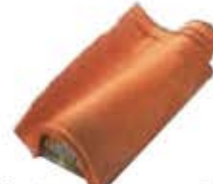
Aeratore per Unicoppo Extra con rete metallica Lunghezza: ~ 450 Larghezza: ~ 260 Peso: ~ 4,3 kg
