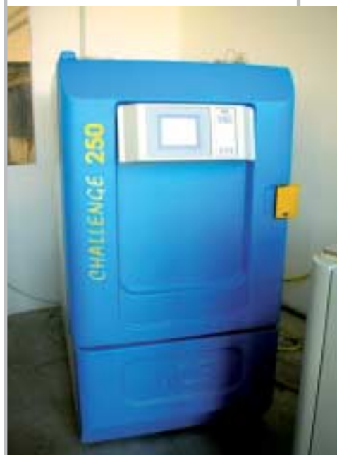
Fig. 2 - Camera Challenge CH250 per le prove di invecchiamento artificiale. Challenge CH250 chamber, for artificial aging test.
