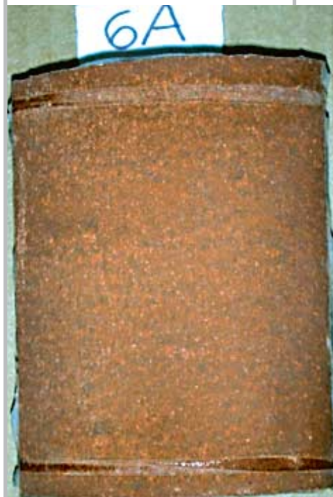
Fig. 7 - Strisce di colorazione originaria non intaccate dall'azione degli UV a causa del posizionamento degli elementi di fissaggio utilizzati durante le prove. Strips of the original colour which have not been affected by the UV rays due to the presence of positioning elements used during the tests.
