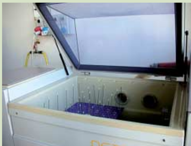
Fig. 3 - Vano di carico dell'apparecchiatura per il test in nebbia salina. The compartment of the salt spray test apparatus.
