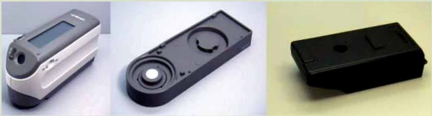
Fig. 5 - Lo spettrofotometro Konica Minolta CM2600D (a sinistra), il piatto di calibrazione del bianco (al centro) e la scatola di calibrazione del nero (a destra).
