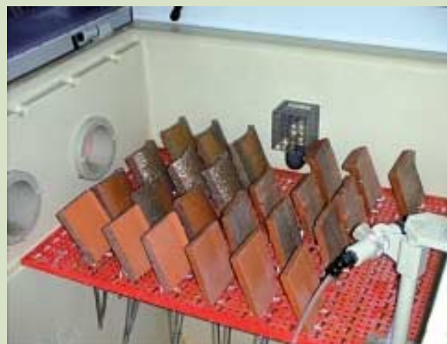
Fig. 4 - Posizione di una serie di provini nell'apparecchiatura per il test in nebbia salina. Samples positioned inside the salt spray test apparatus.
